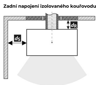
Prostup kouřovodu stěnou z hořlavé hmoty ČSN 06 1008
