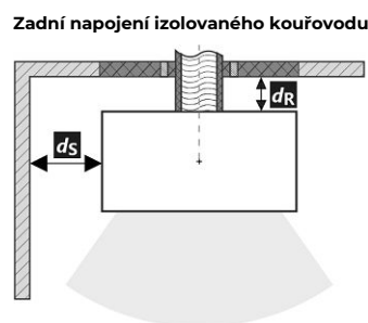
Prostup kouřovodu stěnou z hořlavé hmoty ČSN 06 1008
