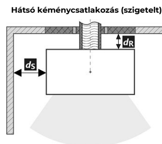
A füstcső áthaladása éghető anyagból készült falon
