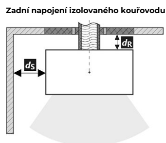
Prostup kouřovodu stěnou z hořlavé hmoty ČSN 06 1008
