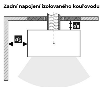
Prostup kouřovodu stěnou z hořlavé hmoty ČSN 06 1008
