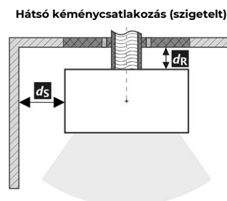
A füstcső áthaladása éghető anyagból készült falon
