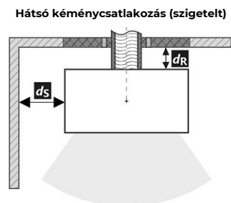
A füstcső áthaladása éghető anyagból készült falon
