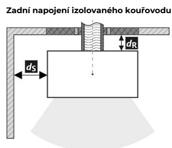
Prostup kouřovodu stěnou z hořlavé hmoty ČSN 06 1008
