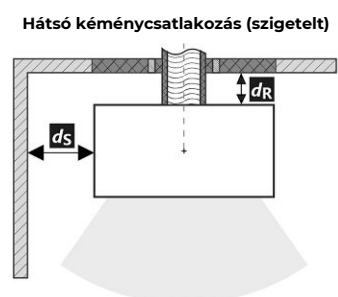
A füstcső áthaladása éghető anyagból készült falon
