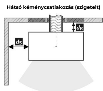
A füstcső áthaladása éghető anyagból készült falon
