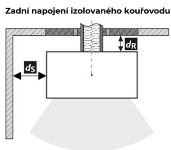
Prostup kouřovodu stěnou z hořlavé hmoty ČSN 06 1008
