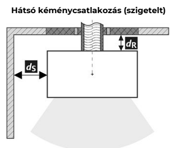
A füstcső áthaladása éghető anyagból készült falon
